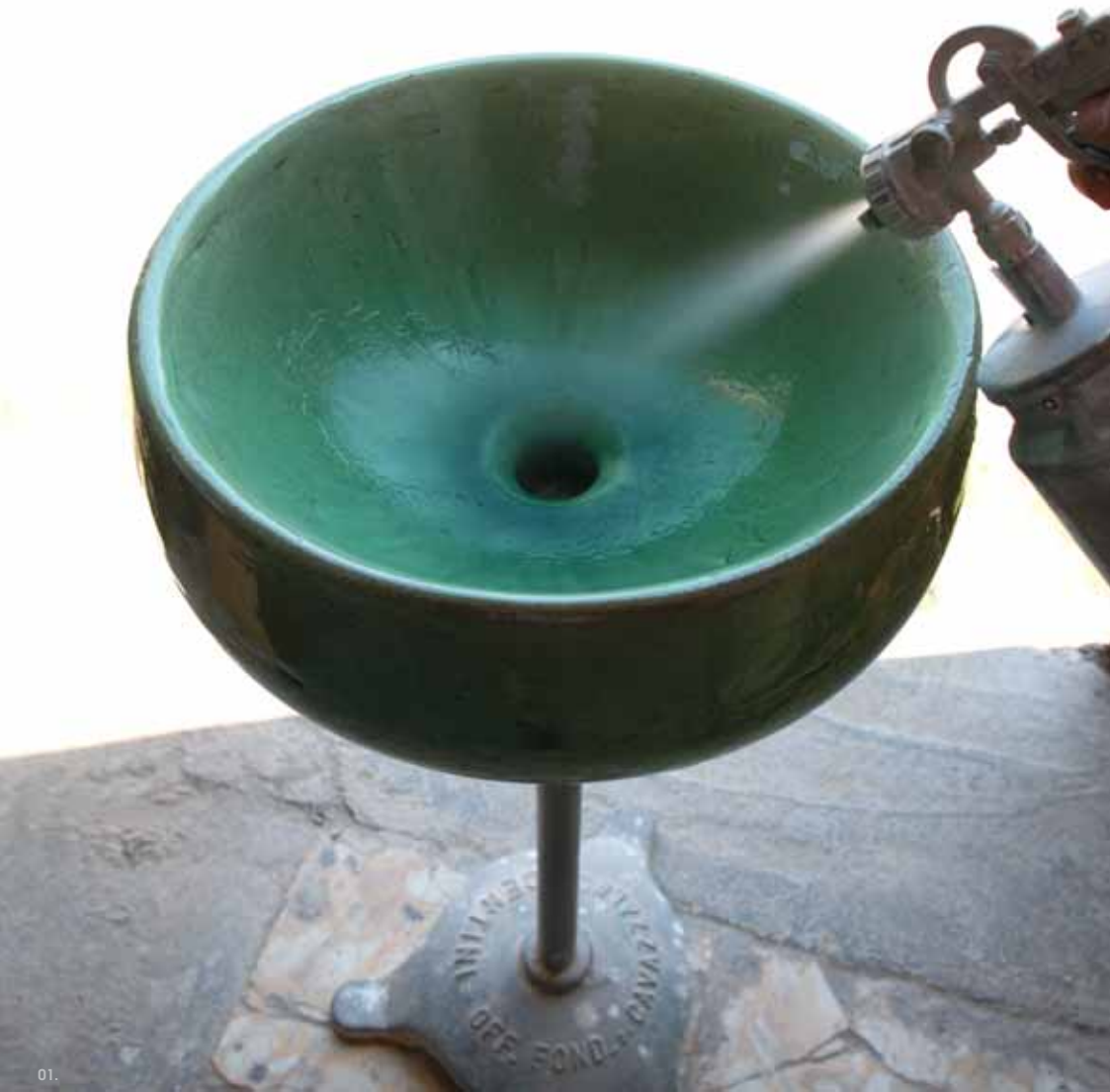
01. particolare della lavorazione di smaltatura per il lavabo appoggio GRAAL detail of the enamelling process of the GRAAL over-counter washbasin
